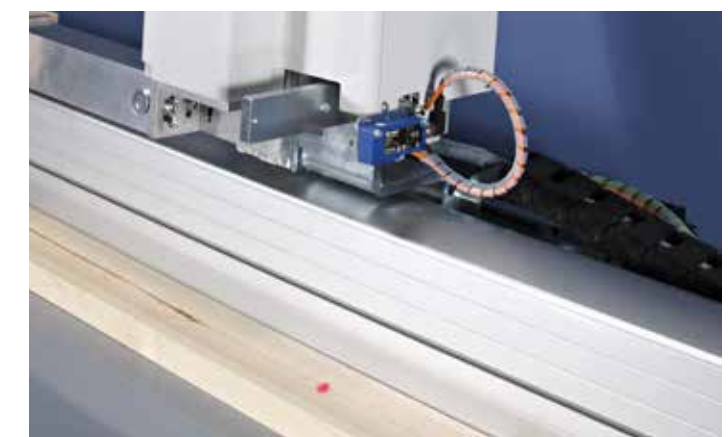
Dettaglio dello spintore con sensore di misurazione pezzo
